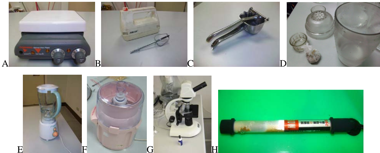
圖三、幾種本實驗使用的器材：A. 電子加熱攪拌器 B. 電動打蛋器 C. 壓汁機 D. 手搖杯 E. 果汁機 F. 調理機 G. Motic 數位顯微鏡 H. 電子恆溫加熱器
