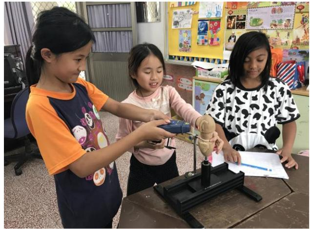
雖然毛線的轉動效率較佳，但較易斷裂，故從差距不大的麻繩、蠟繩、中國結繩、棉繩中，挑選較常見的棉繩來操作實驗。
