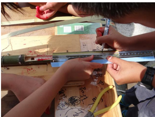
做完 20 次射擊後將竹槍前端切短 5 公分
