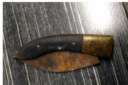
說明：傳統士林刀，須高碳鋼才能打出火星，一般鐵器不易敲擊。
