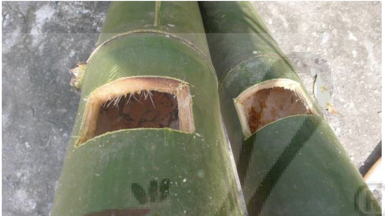
竹孔的位置再結的上方約五公分處，電土的量才夠放。
