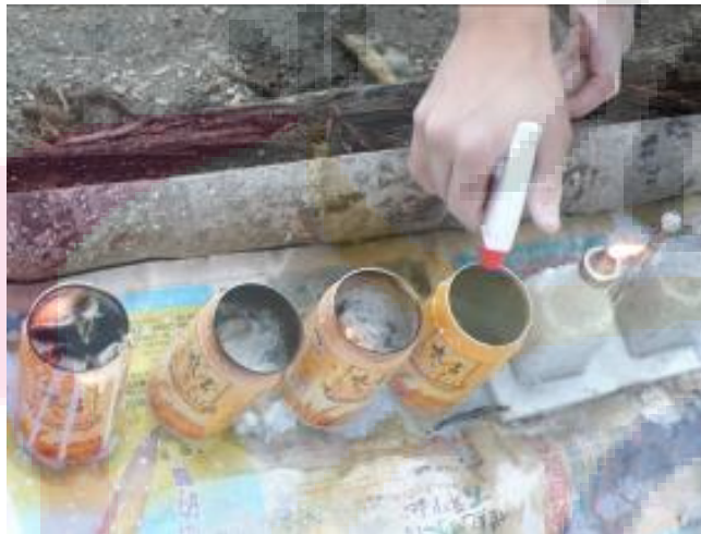
自製電土燈燃燒十分鐘的狀況。火量大小最好的【鐵罐組】依次是： a > c > b > d ， 瓶裝組則是： e > f
