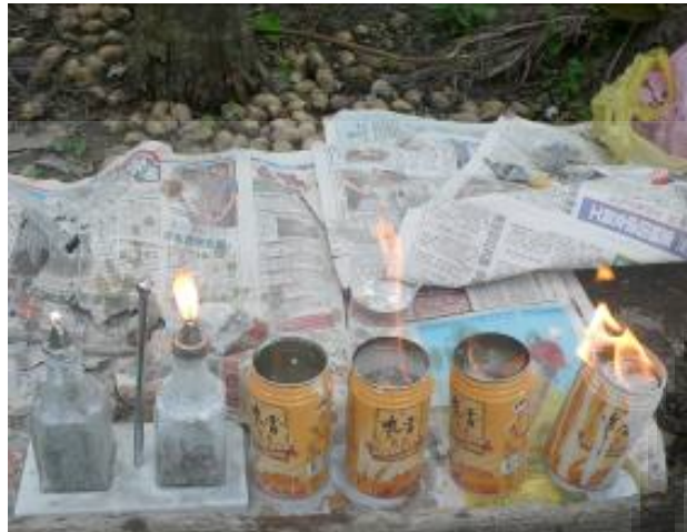
自製電土燈燃燒五分鐘的狀況。火量大小最好的【鐵罐組】依次是： c > a > b > d ， 瓶裝組則是： e > f
