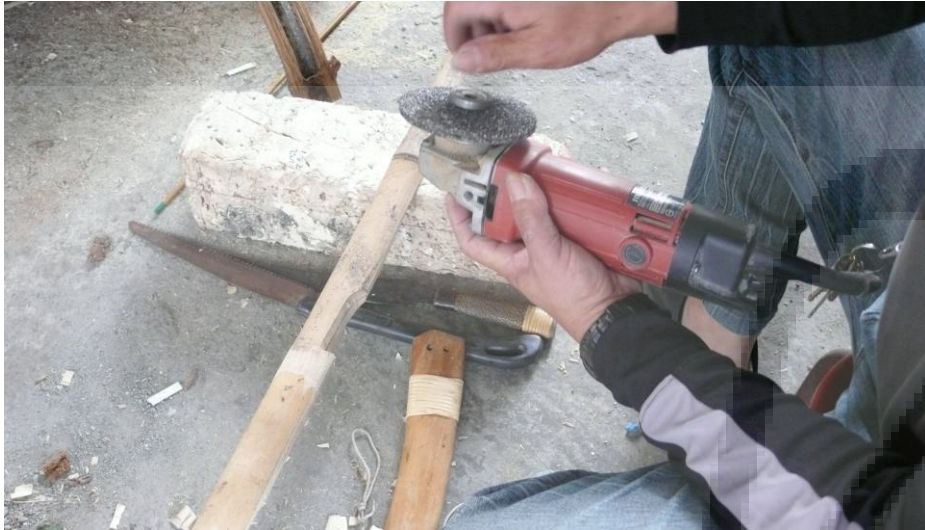
接著耆老將弓槽用砂輪機把較粗糙的地方大至磨細滑。
