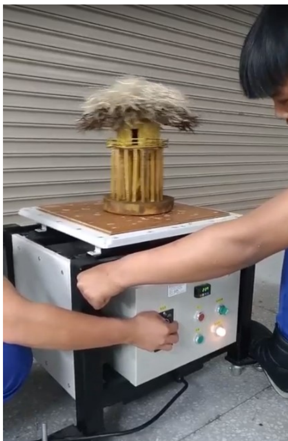
圖十二 Trakuban建築模型承受單軸振動台到達高轉速
