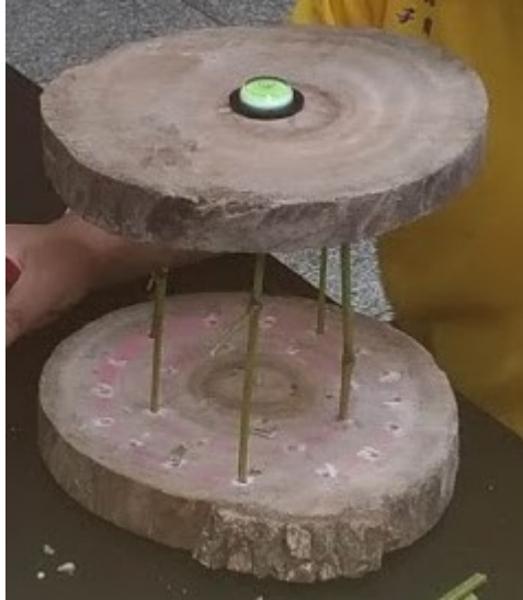
圖八 用圓形水平儀確認水平狀況
