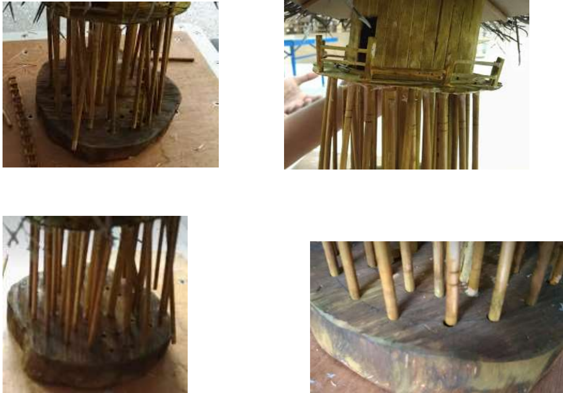
圖十三 地震模擬高速試驗結果損壞照
