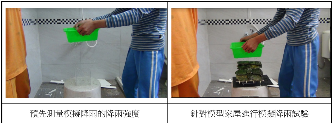
圖 5 屋頂防水試驗情形
