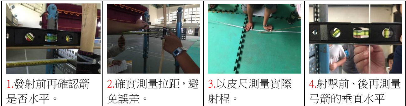
圖 5-3-5 探討「拉距」和「射程」變化關係實驗說明圖
