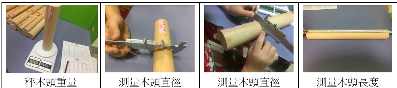
圖 5-6-1 測量各種不同材質直徑、重量、長度說明圖
