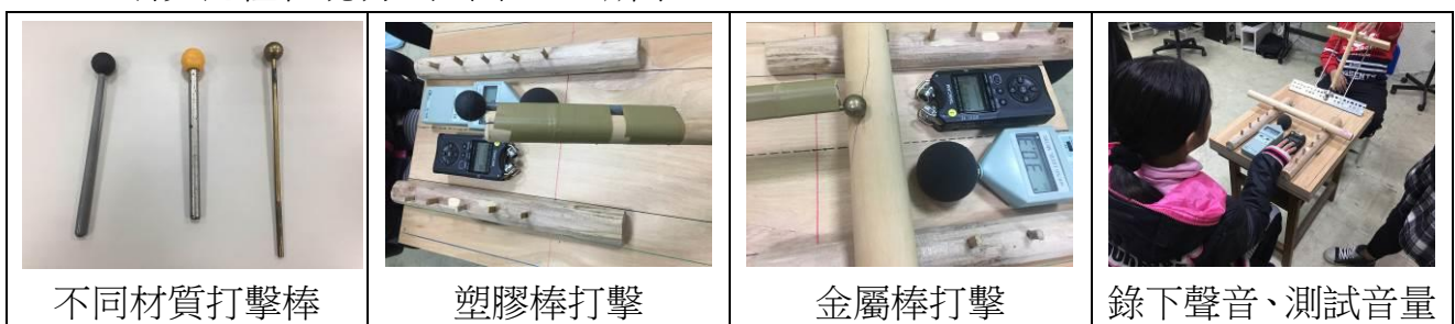
圖 5-3-1 不同材質的打擊棒和琴鍵「音調」、「音量」實驗過程說明圖
