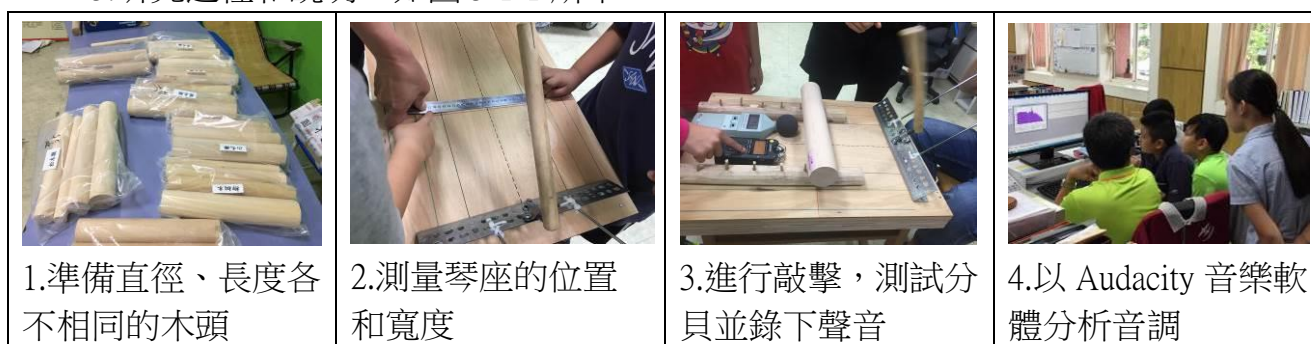
圖 5-1-1 探討木琴「琴座寬度」和「音調」、「音量」的變化關係實驗過程說明圖
