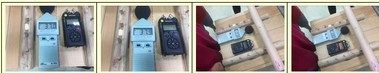
圖 4-6-3 實驗的地點環境分貝測試說明圖
