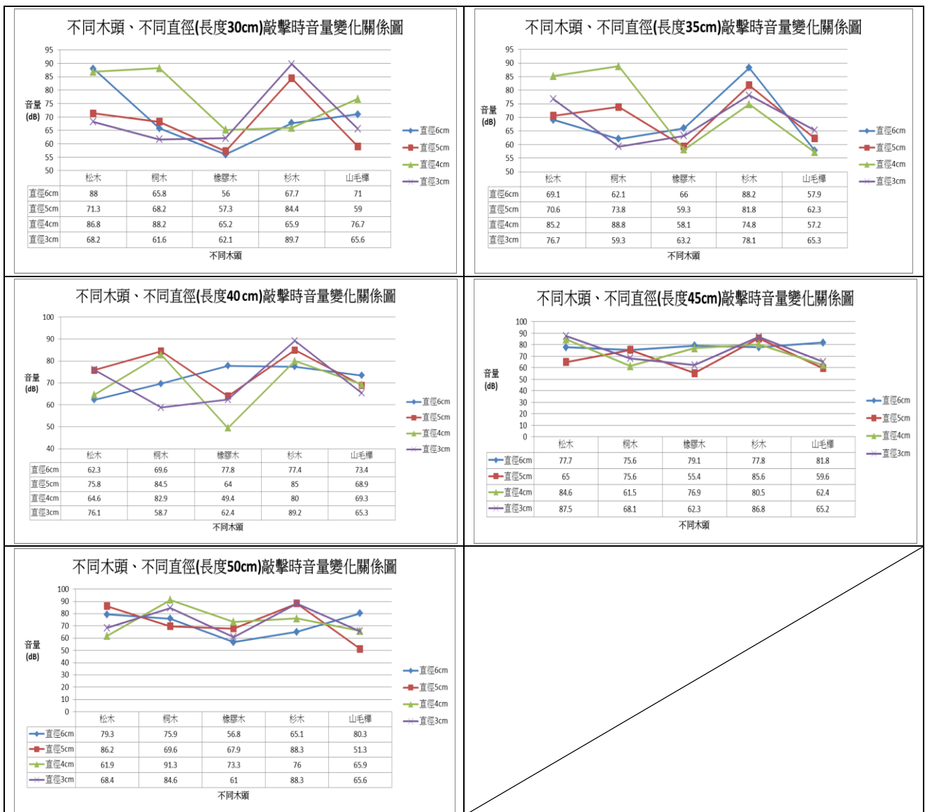
圖 5-5-2 敲擊不同木頭、不同琴鍵長短、直徑的『音量』變化關係結果說明圖
