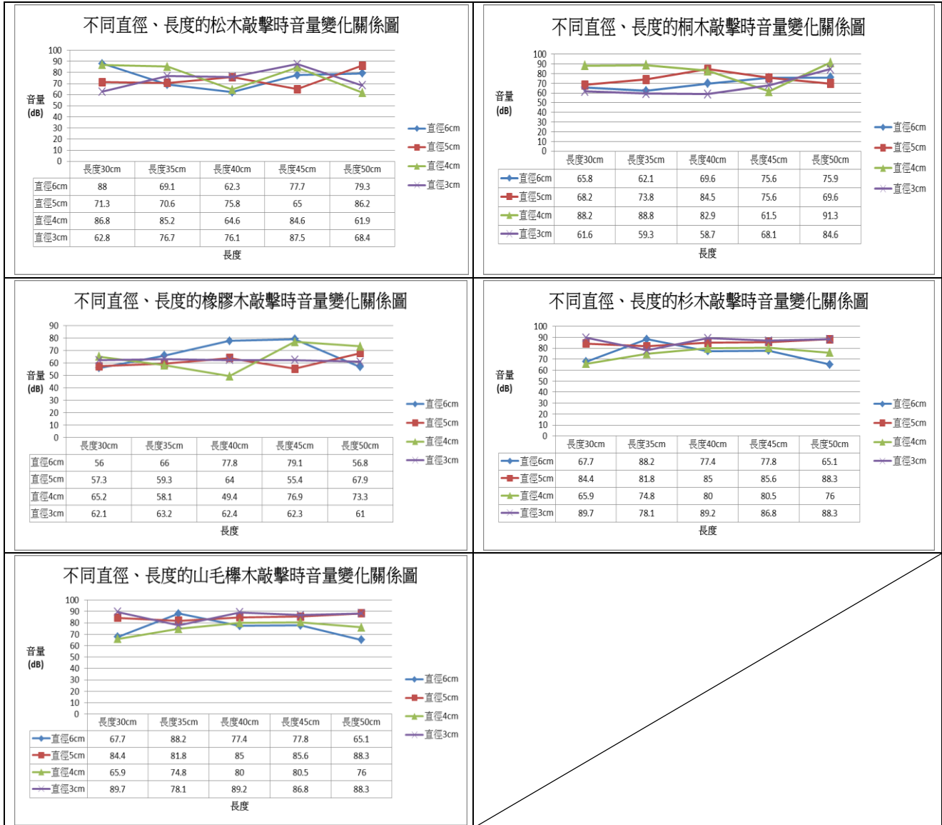
圖 5-4-3 敲擊不同琴鍵長短、不同直徑的木頭『音量』變化關係結果說明圖
