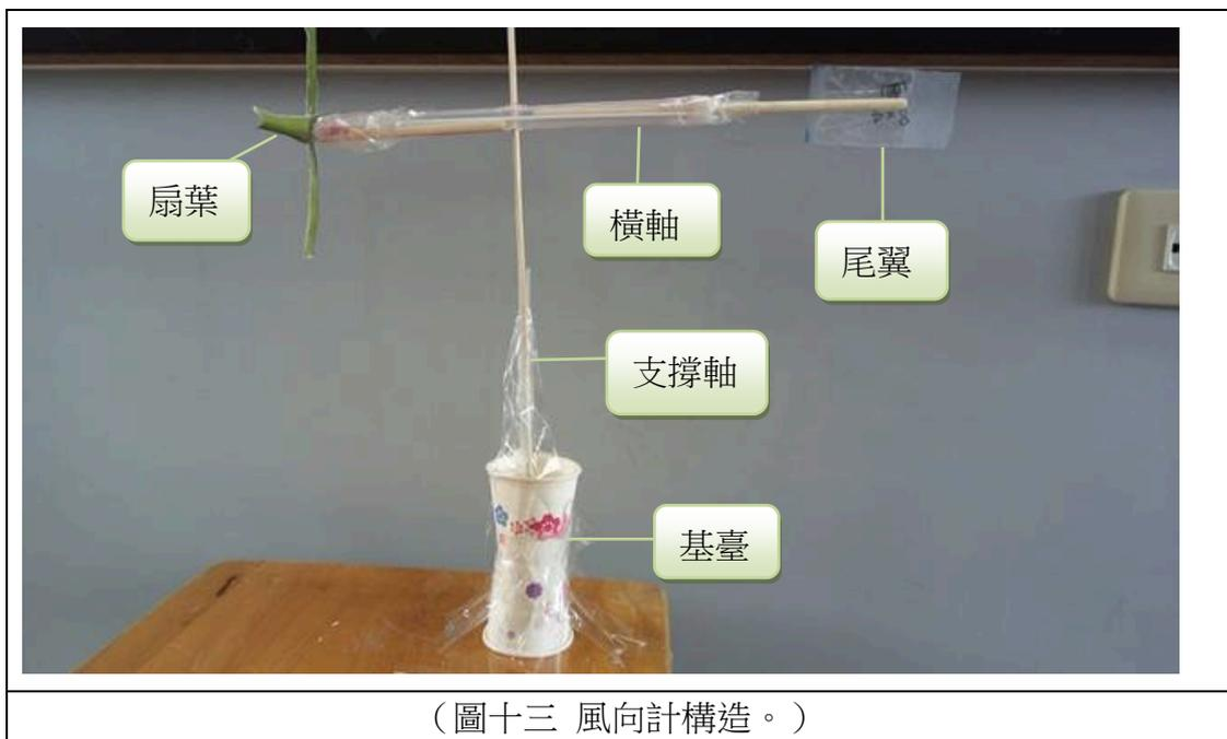
1. 扇葉的製作：扇葉主要是由林投葉所製成，總共有四片。我們想知道哪種面積能最快感應到風向，因此我們將寬定為固定的 1.5 公分，因為去除林投葉的葉脈後，葉子寬度為 1.5 公分，並將長定為 1、2、3、4、5、6、7 公分，組合成不同的面積，分別為 1.5×1、1.5×2、1.5×3、1.5×4、1.5×5、1.5×6、1.5×7 共 7 種組合。每種面積都各剪四片，剪好後用膠帶將
